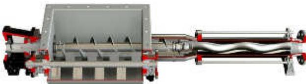
Trichterpumpe mit großem Einlauftrichter, Zuführschnecke und seitlichem Brückenbrechen, ideal für schwer fließfähige, zu Brückenbildung neigende Medien. Standard Material: Edelstahl AISI 304 oder AISI 316
