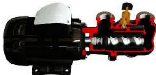
Die kompakteste der Wobbelpumpen ist die R Baureihe, die den direkten an das Pumpengehäuse geflanschten Motor und eine extreme kompakte Geometrie der Fördererelemente vereint. Für extreme Wartungsfreundlichkeit sorgt hier neben dem Wegfall der Laterne auch ein zuverlässiges Kreuzgelenk in der Antriebswelle.
