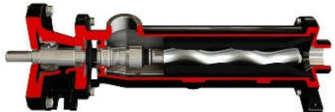
Die RJL Baureihe ist grundsätzlich ähnlich aufgebaut wie die RL Reihe, allerdings verfügt sie über eine eigene Lagereinheit mit freiem Wellenende. So kann sie mit jedem geeigneten Antrieb über eine flexible Kupplung verbunden werden. Die pumpeneigenen Lager sorgen zuverlässig für hohe Standzeiten bei den verschiedensten Einsatzparametern.
