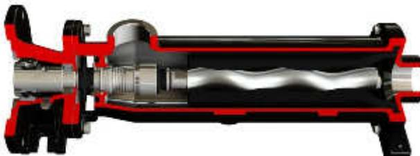
Die RFL Reihe ist nahezu baugleich mit der RJL Reihe, inklusive allen o.g. Vorteilen. Anders als bei der RJL Reihe wird diese Version jedoch mit Hohlwelle und Flansch anstatt freiem Wellenende geliefert, sodass jeder IEC B5 Normmotor in passender Größe direkt angeflanscht werden kann.
