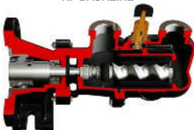
Die RF Baureihe ist weitestgehend baugleich mit der R Reihe, jedoch verfügt diese über eine eigene Lagereinheit mit Steckwellenverbindung und Flansch, die in den üblichen IEC Abmessungen bestellt werden können. Stabile, große Lager garantieren hohe Zuverlässigkeit und lange Standzeiten.
