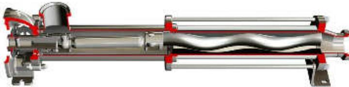
Die DXO ist die Hygiene-Pumpe mit offenen, aseptischen Gelenken. Rotierende Teile sowie auch das Gehäuse werden zu jeder Zeit umspült und bilden keine toten Ecken. Das macht sie zur 100% hygienisch einsetzbaren Lösung für den Prozess. Die offenen Bolzengelenke sind medium-geschmiert und erreichen, solange wenig abrasive Stoffe enthalten sind, extrem lange Lebensdauer, Fördermedien mit schmierenden Eigenschaften verlängern die Lebensdauer zusätzlich.
