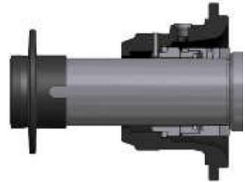
**Protection du joint :** Dans la série DHS e JHS le manchon de couplage et la bride sont protégés par une composante intégrée notamment aux extrémités de la vis d'Archimède. Cette caractéristique est d'une importance considérable, car elle garantit l'intégrité de l'articulation dans le cas de pompage de substances abrasives ou avec des solides contondants, sans qu'il soit nécessaire d'ajouter des composantes optionnelles coûteuses.
