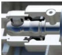
Protection du joint intégré à l'extrémité de la vis d'Archimède Fondamentale pour le pompage de fluides abrasifs ou contenant des solides contondants
