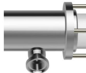
Connessione CIP realizzata nel corpo pompa. Tale opzione consente di introdurre nel corpo pompa fluido di lavaggio in modo da pulire nel miglior modo le pompe in ambito sanitario. Realizzato in tangenza al corpo evita ristagni nello stesso consentendo un drenaggio
